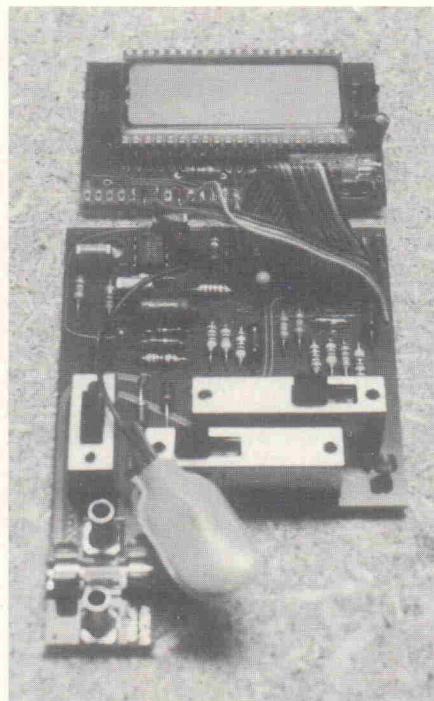
Die fertig bestückten Multimeter-Platinen
